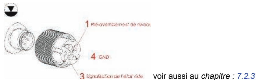
Fig. 12.5 Raccord du pré-avertissement de niveau ou signalisation de l'état vide
