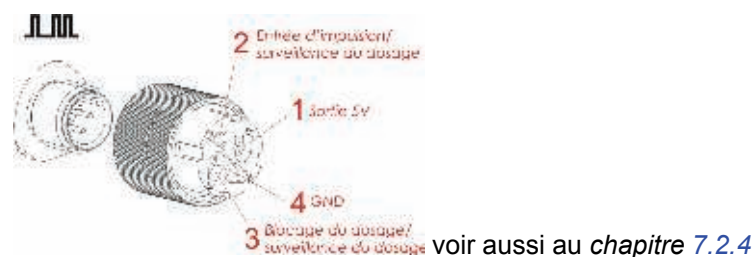
Fig. 12.6 Raccord de l'entrée d'impulsion et blocage du dosage
