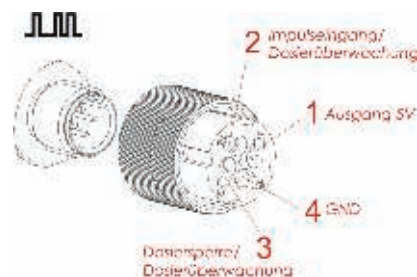
Abb. 12.6 Anschluss Impulseingang und Dosiersperre
